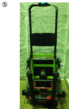
⑤赤いパイプを前に押し昇降レバーを下げます。
