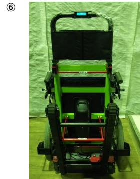
⑤赤いパイプを前に押し昇降レバーを下げます。
