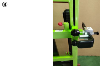
⑧車椅子固定具レバーで固定具左右抜きます。
